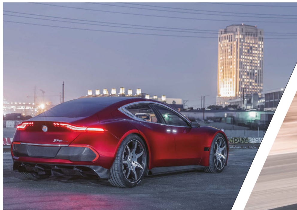
車身尺碼：5,085 x 1,465 mm 軸距：3,018 mm 動力：電動馬達 最大馬力：780 hp 最大扭力：966 Nm 續航力：643 km
